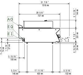
Electrical inlet (power) EQ **Equipotential screw**
